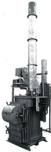
送風機を設置し、焼却炉内に効率良く空気を送ることで、燃焼効率を高めた。高い集じん能力を持ち、煙の排出量が少ない。投入口は、全面
