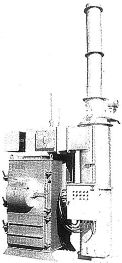
廃棄物燃焼炉を製造、販売するDAITO(ダイト)は、廃プラスチック対応燃焼炉「ISR-R」モデルから新たに「ISR-500J」を発売した。水冷式で廃プラスチックを長時間安定して燃焼でき、1時間当たり29キロのごみを燃却できる。
