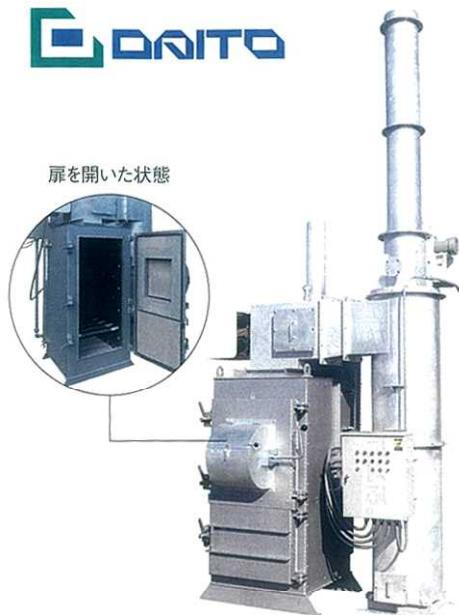
自治体への設置届出が不要な小型焼却炉。そのなかでも「ISRモデル」は、黒煙が出やすいプラスチックの焼却に特化したタイプだ。水冷式に火格子（水管ロストル）を装備。高い燃料効率と長時間の安定燃焼を可能にした。
